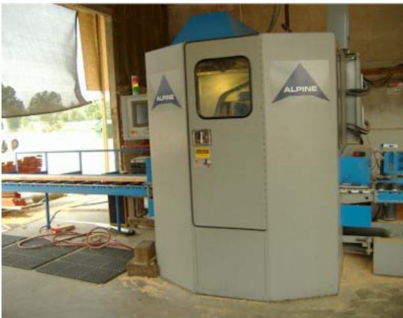
この機械はコンピューター制御され、トラスを作るための ダグラスファーを正しく、自動的にカットします
