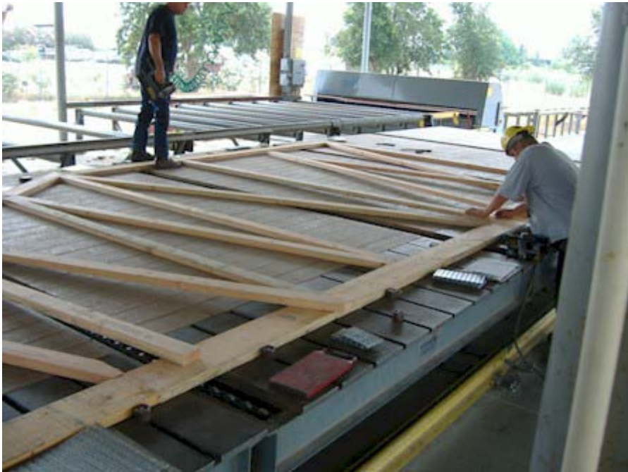
正しくカットされたトラス材を製作台上に正しくセットアップしています
